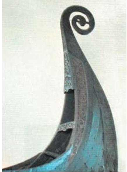
Bildet viser «halsingen» og «vinstaven» som integrert del av stavnen på Osebergskipet [HPIM2358]
