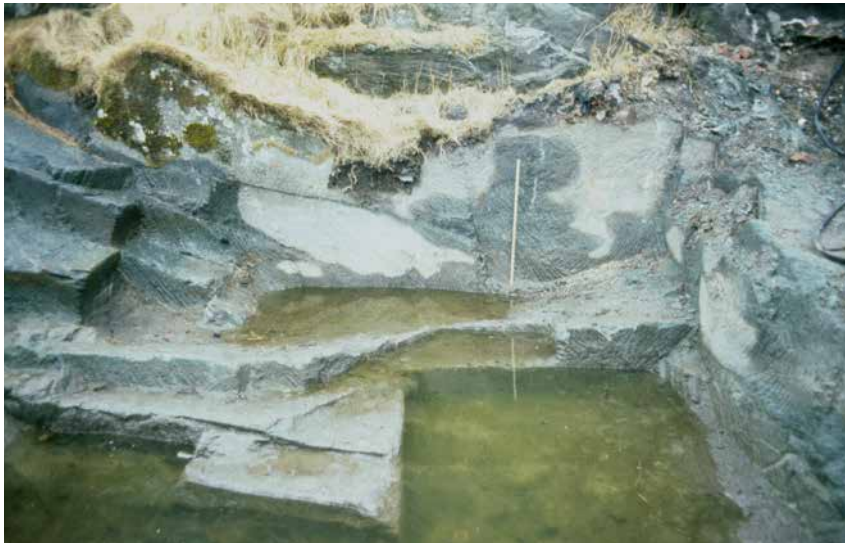
Klebersteinsbrudd i Tornes ved Haugesund. Man ser tydelig metoden man brukte for å løse ut firkan- tede steinblokker. Steinen ble delvis formet til en blokk før den ble kilet ut. Ofte ser vi disse sporene fra steinbruddet på de uthogde kleberstein som har blitt tatt ut av murverk. Sporene fra stein- bruddet vendte naturlig nok inn i murverket og skulle derfor ikke være synlige. Foto: Arvid Lilleham- mer, Arkeologisk museum – Univer- sitetet i Stavanger.
